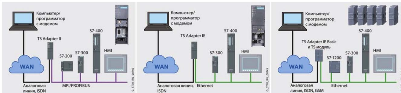
Пакет TeleService позволяет осуществлять дистанционное обслуживание систем автоматизации SIMATIC S7/ C7/ WinAC с программатора или компьютера, связанного с системами автоматизации через телефонные или радиоканалы. Для обслуживания может быть использован весь спектр промышленного программного обеспечения SIMATIC. Используемый канал связи по своим функциональным возможностям аналогичен интерфейсу программирования соответствующей системы автоматизации.
